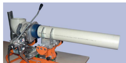
закрепление в аппарате и центровка, потом нагрев
