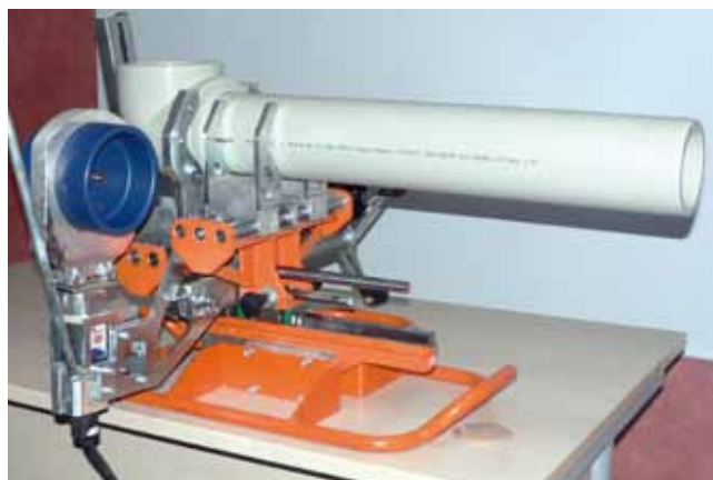
готовое сварное соединение после охлаждения
