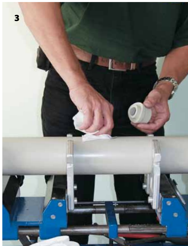
3 Вварное седло надеть на насадку так, чтобы были совмещены метки на седле и насадке. Прогреть отверстие и свариваемое седло. Время прогрева как у трубы диаметром 32 мм – 8 с. Для сварных седел 110 x 32 и 110 x 40 время нагрева такое же, как для диаметра 40 мм – 12 сек.
