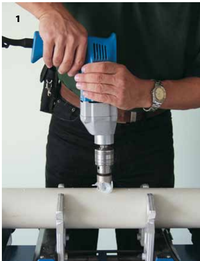
1 Специальной фрезой высверлить отверстие для седла
