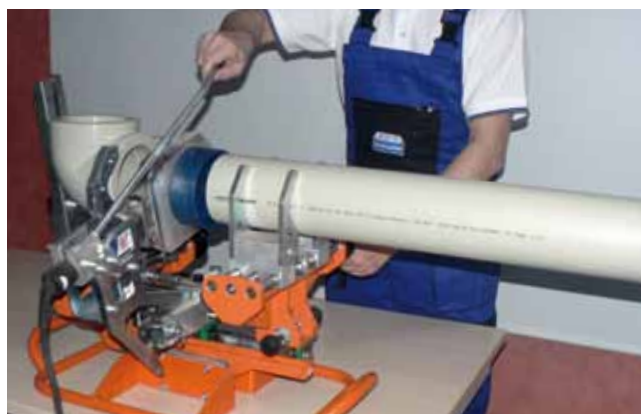
закрепление в аппарате и центровка, потом нагрев
